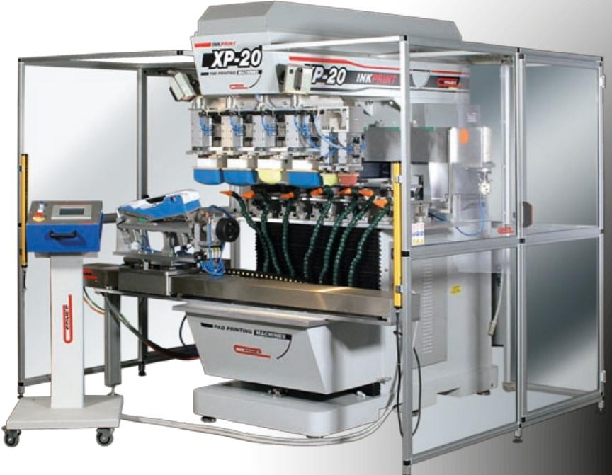
**INKPRINT XP-20 5C T.I.** con calamaio ermetico ed anello in ceramica Ø200mm., completa di transfer lineare modello step 1400, rotazione pezzo di 180°, essiccatore ad aria calda tipo Hot Wind 200 e discesa indipendente dei tamponi.
